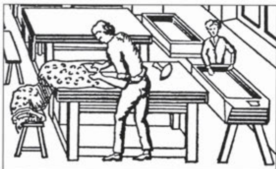
Impression de toiles à l'aide de planches gravées. A côté de l'imprimeur, son garçon tireur veille à la propreté des planches et l'aide à étaler la couleur.
